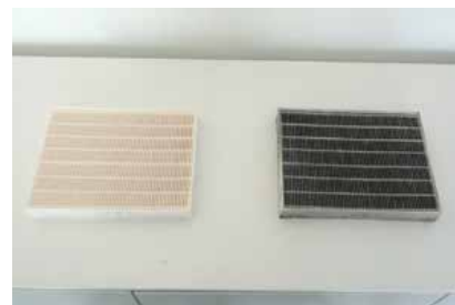
汚染対策の換気設備 左:使用前のフィルター 右:使用後6カ月のフィルター
