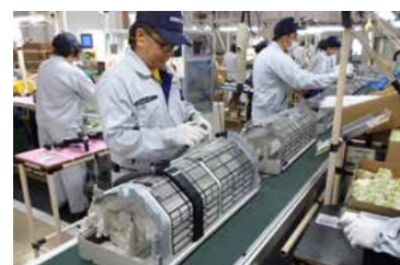
再生材を使った部材の組立工程
